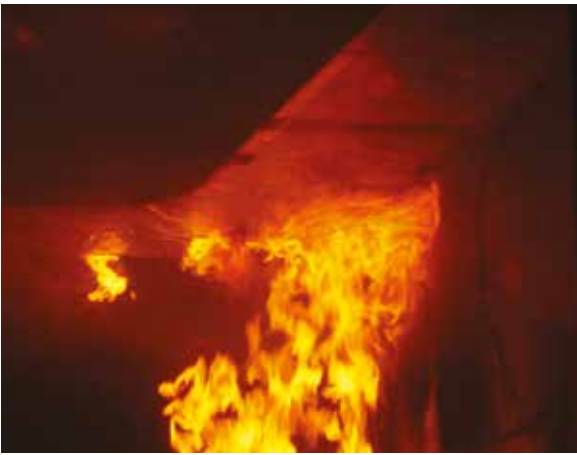
Fig. 15 - Ataque térmico a 300 kW (incendio generalizado)
