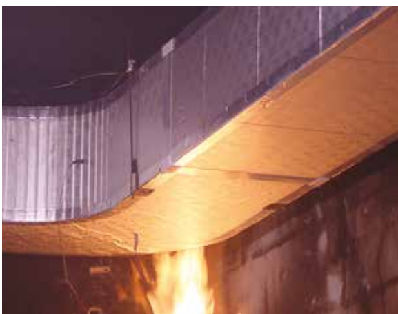
Fig. 14 - Ataque térmico a 100 kW (incendio en desarrollo)
