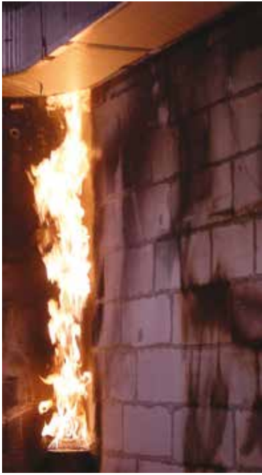
Fig. 9 - Simulacro de incendio con el "room corner test"
